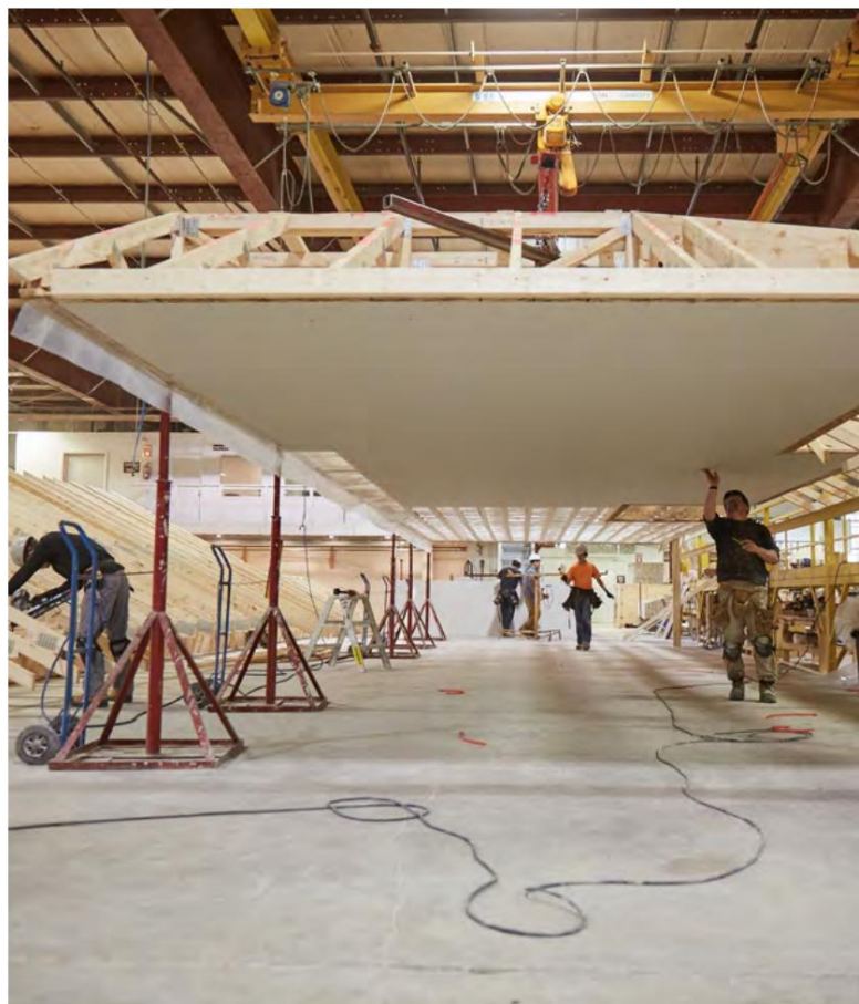
图片 10:工厂中的工人正在准备屋顶结构的不同部分。
