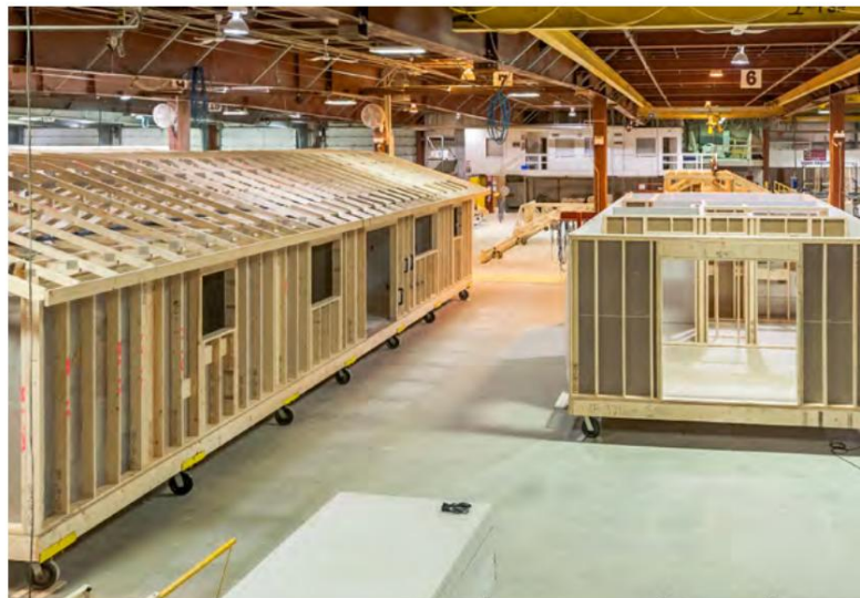
图片 11:制造工厂中两个部分完成的模块。
